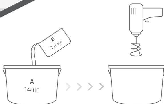
Двухкомпонентный полисульфидный герметик с повышенной стойкостью к воздействию УФ, выдерживает кратковременный контакт с грунтовыми водами и нефтепродуктами.
